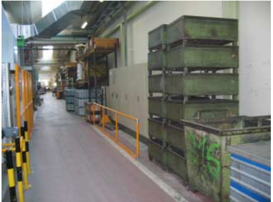
Bild3 Aufbau von klaren Materialfluss-Strukturen und Kennzeichnung der Transportwege
